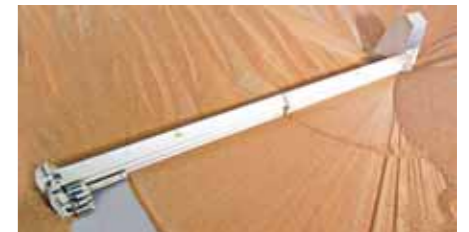
Golire pâlnie siloz cu ajutorul șneului măturător
