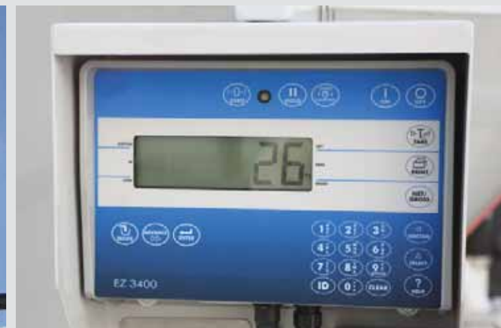
Sterownik z możliwością zaprogramowania 99 mieszanek z 99 komponentami. Компьютер для 99 рецептов с 99 компонентами.
