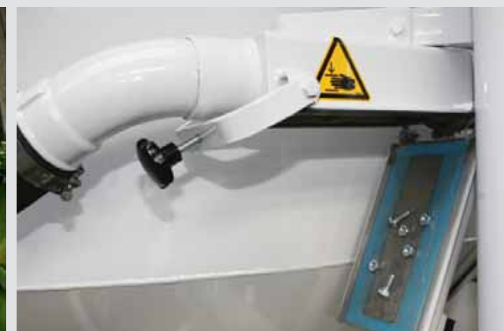
Magnes na rurze ssącej do oddzielenia części metalowych. Магнитная защита на загрузке.
