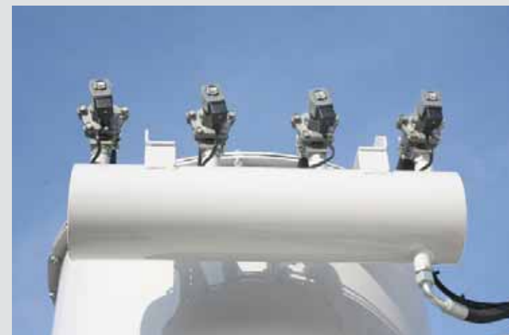
System filtrów z 12 tulejami. Czyszczenie odbywa się poprzez zawory pneumatyczne. Система фильтрации с 12-ю патронами. Очистка происходит посредством пневматических клапанов.
