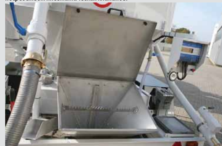
Zbiornik na komponenty z worków, wykonany ze stali nierdzewnej. Воронка из нержавеющей стали для твердых компонентов в мешкотаре.
