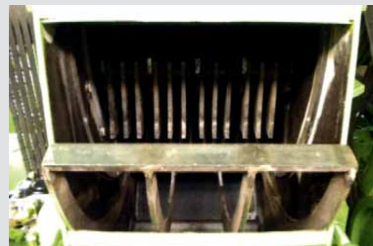
Śrutownik z 72 bijakami widiowymi. Rama na sita siatkowe w 10 różnych wymiarach oczek, wzm. 380/800 mm. Молотковая дробилка с 72 молотками. Решетная рама для плетеных сит с 10 размерами ячеек. 380 мм ширина/Ø 800 мм.
