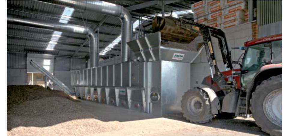
Geschlossener Schubwendetrockner für Holzhackschnitzel in der Praxis.
