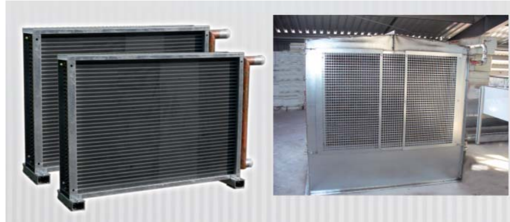
Der Warmwasseraustauscher des Schubwendetrockners offen und mit Einhausung.
