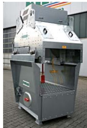
Der Schubwendetrockner wurde bereits in den Breiten 1- und 2-Meter ausgeliefert. Die Konstruktionspläne für einen 3-Meter Schubwendetrockner sind schon vorhanden.
