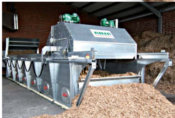
Der Schubwendetrockner wurde bereits in den Breiten 1- und 2-Meter ausgeliefert. Die Konstruktionspläne für einen 3-Meter Schubwendetrockner sind schon vorhanden.
